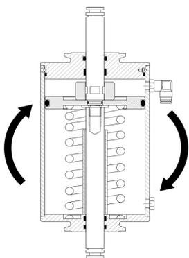
Posee un actuador rebatible para convertirla facilmente de normal cerrada a normal abierta sin necesidad de desarmar el actuador neumático. Simplemente se desacoplan las abrazaderas, se invierte el actuador  $180^\circ$  y se vuelven a acoplar las abrazaderas.
