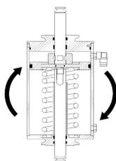
La VEH posee un actuador rebatible para convertirla fácilmente de normal cerrada inferior a normal cerrada superior sin necesidad de desarmar el actuador neumático.
