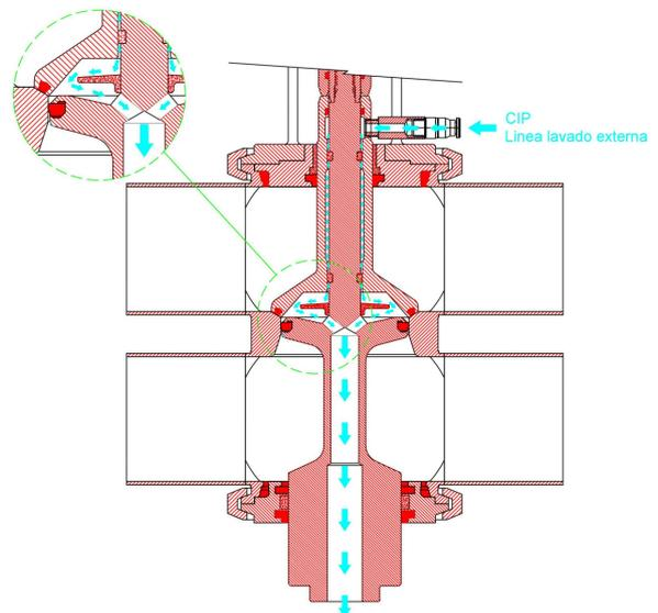
Estando la válvula en posición de reposo, se le hace el ingreso CIP por el racor que se encuentra en la parte superior del vástago. La solución de limpieza, limpiará la cámara y drenará por el testigo de fuga.
